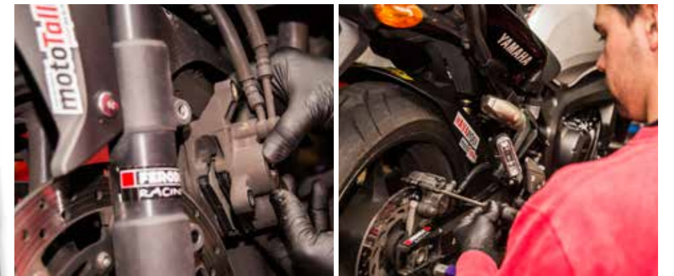
Iniciamos nuestra prueba instalando las pastillas en el eje delantero (dos pinzas) y trasero de la Yamaha FZ6 de Héctor. Nada remarcable que comentar con respecto a la instalación, que no difiere en absoluto de la de cualesquiera pastillas convencionales.
