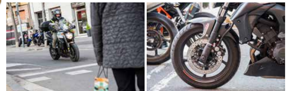
Una vez en marcha, iniciamos el rodaje de ambos juegos de pastillas en las dos motos. Pasados los primeros kilómetros, aproximadamente unos 100 con sus respectivas frenadas, las pastillas ya se habrán acoplado correctamente a los discos y pistas del tambor y empezará su vida real. Enseguida notamos que el rendimiento de las pastillas es muy alto, incluso en situaciones de alta demanda, frenando a altas velocidades de autopista y con carga en la moto, en el caso de la Yamaha. La Honda en recorridos urbanos demuestra la alta calidad de las Ferodo ECO-FRICTION en silencio... Nada de chirridos y mínimas vibraciones por fricción con los discos.
